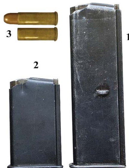
1. сменный коробчатый магазин на 20 патронов 7,63 мм; 2. сменный коробчатый магазин на 10 патронов 7,63 мм; 3. французский патрон и гильза 8х27 мм Mle.92
