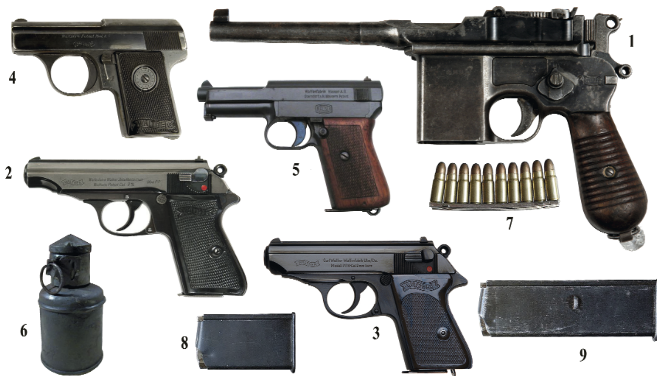
Оружие убийц: 1. автоматический пистолет 7,63 мм «Маузер-Вестингер» обр. 1932 г.; 2. пистолет 7,65 мм «Вальтер» ПП; 3. пистолет 6,35 мм «Вальтер» ППК; 4. пистолет 7,65 мм «Вальтер» № 9; 5. пистолет 7,65 мм «Маузер» обр. 1910/14 гг.; 6. итальянская ручная граната П.О.; 7. обойма на 10 патронов 7,63х25 мм; 8. сменный, коробчатый магазин на 10 патронов 7,63 мм; 9. сменный, коробчатый магазин на 20 патронов 7,63 мм
